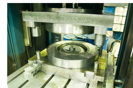
Tłocznik wykonany wg diagramu „solid to solid”
