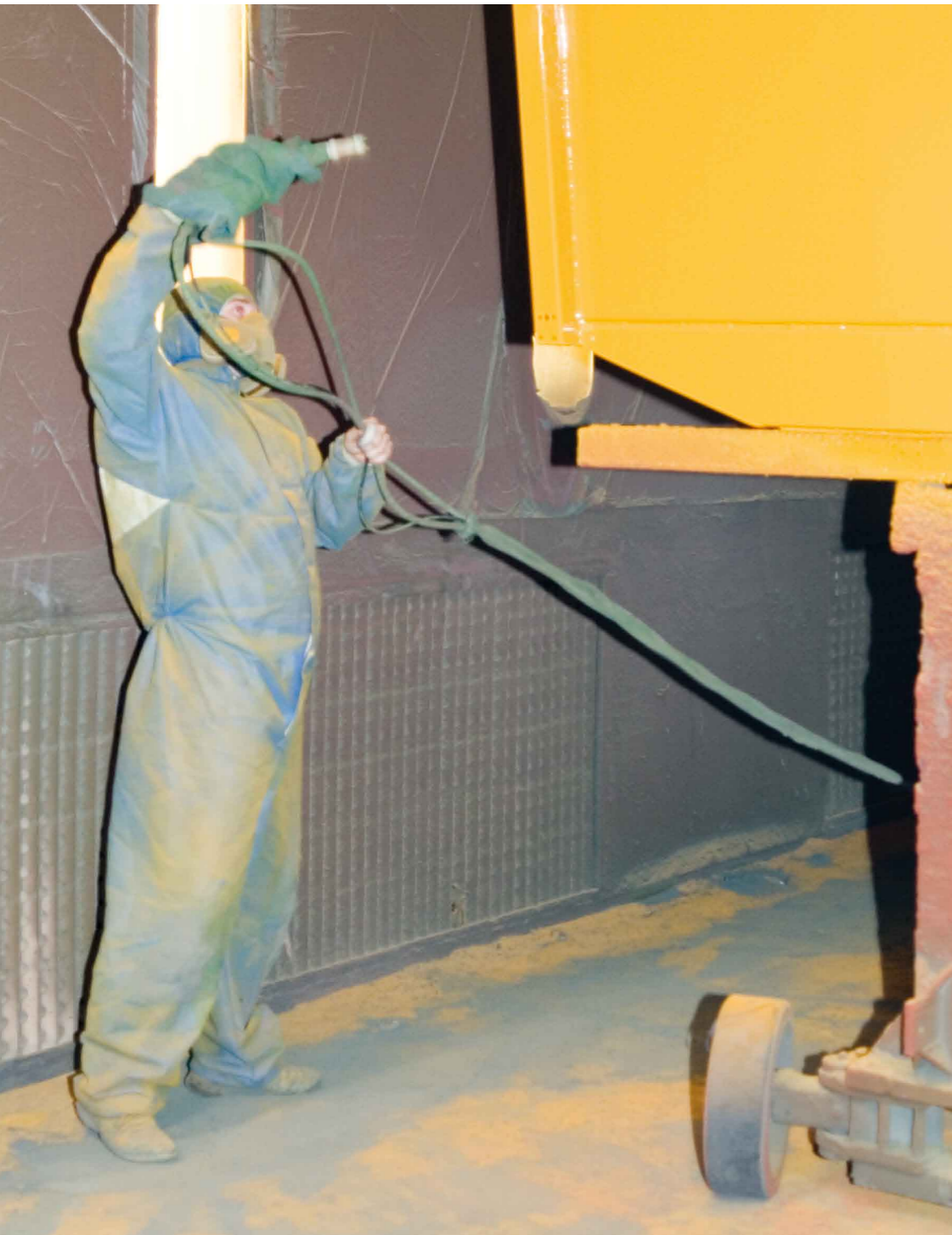
Lakierowanie przyczepy T679/2 metodą elektrostatyczną w komorze lakierniczej. Dzięki zastosowaniu precyzyjnego systemu dozowania uzyskujemy, odpowiednią grubość lakieru
