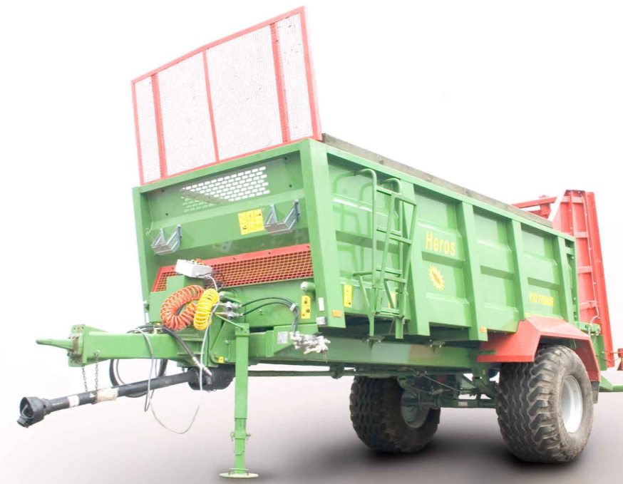
Skrzynia ładunkowa rozrzutnika jest wzmocniona aż czterema słupkami
