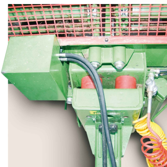
Amortyzowany dyszel minimalizuje przenoszenie uderzeń i drgań na maszynę oraz ciągnik
