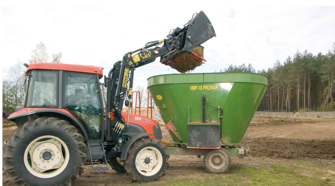
Wycinak kiszonki zamontowany na ładowaczu czołowym umożliwia przewóz wyciętych bloków paszy do miejsca skarmiania
