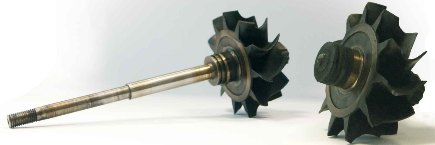
Uszkodzenie wirników turbiny spowodowane brakiem smarowania lub nie wystarczającym smarowaniem
