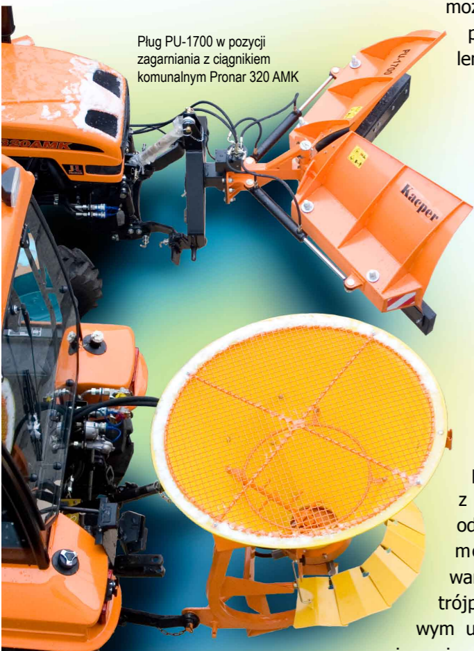
Posypywarka piasku i soli PS-250 z widocznym lejkiem
