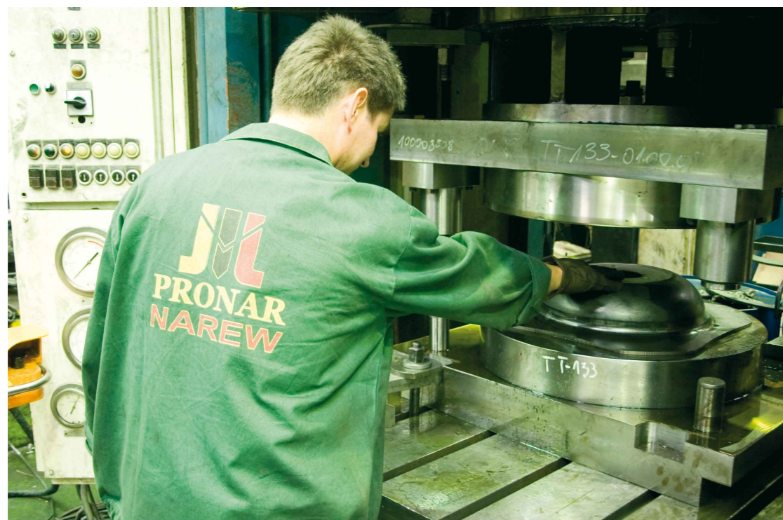
Tarcza - część koła tarczowego wykonana na tłoczniku wykonanym nową metodą
