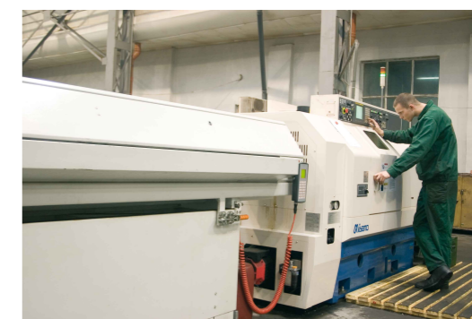
Nowoczesne centrum tokarskie na potrzeby produkcji elementów siłowników hydraulicznych
