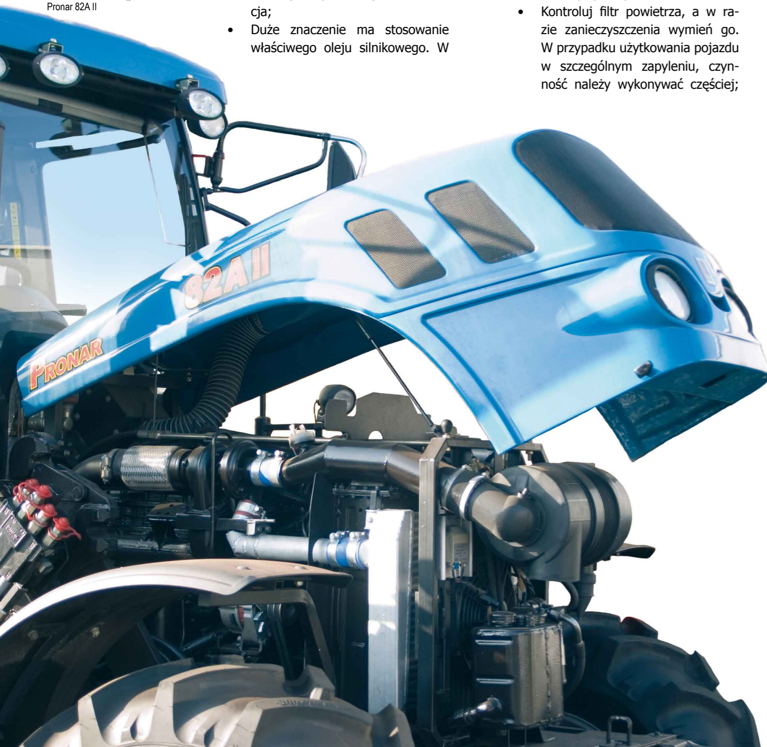
Przykład instalacji turbosprężarki z intercoolerem w ciągniku Pronar 82A II
