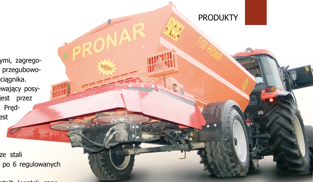
Hydrauliczny napęd talerzy zapewnia cichą pracę bezawaryjną obsługę mechanizmu rozsiewającego
